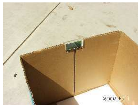
Le carton avec le prisme inséré dans l'encoche. © IPAC
