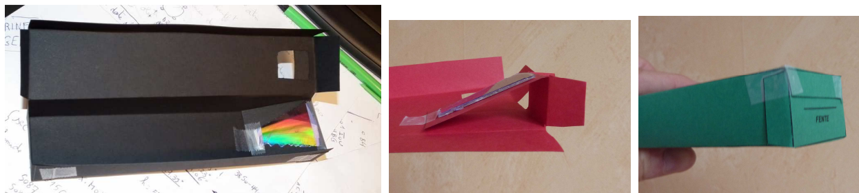
Spectroscopie en réflexion : boîte ouverte (montrant la position du morceau de DVD) à gauche, zoom sur le positionnement de la partie accueillant le DVD au milieu et zoom à droite sur la boîte fermée, pour montrer comment se placent les rabats. © GAPHE
