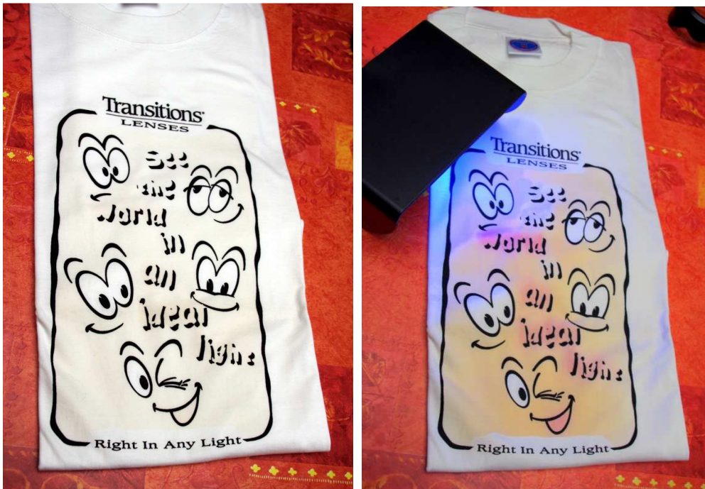
T-shirt réactif à l'UV : état initial (à gauche) et état final après éclaircissement par une lampe UV ou le Soleil (à droite). Certaines perles pour enfants présentent aussi les mêmes propriétés : blanches à la lumière normale, elles se colorent en plein Soleil ou sous une lampe à UV. ©GAPHE
